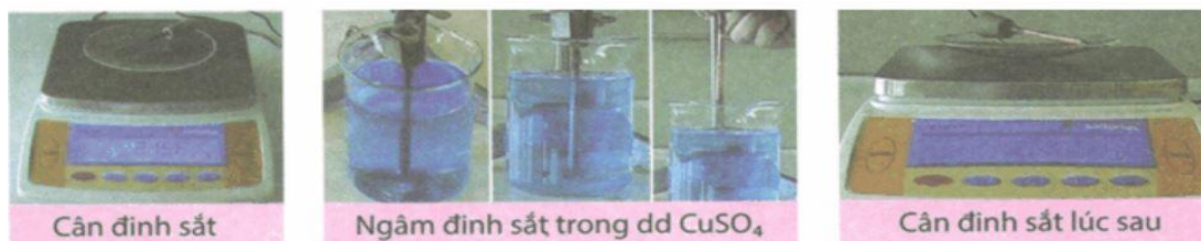
Hình 1.67. Thí nghiệm ngâm đinh sắt trong dung dịch đồng sunfat
